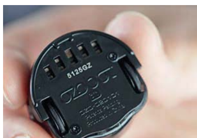
2 Les deux roues motrices et les cinq capteurs optiques sous le robot
